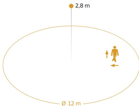
Possibile altezza di montaggio: 2,50 m - 3,50 m
